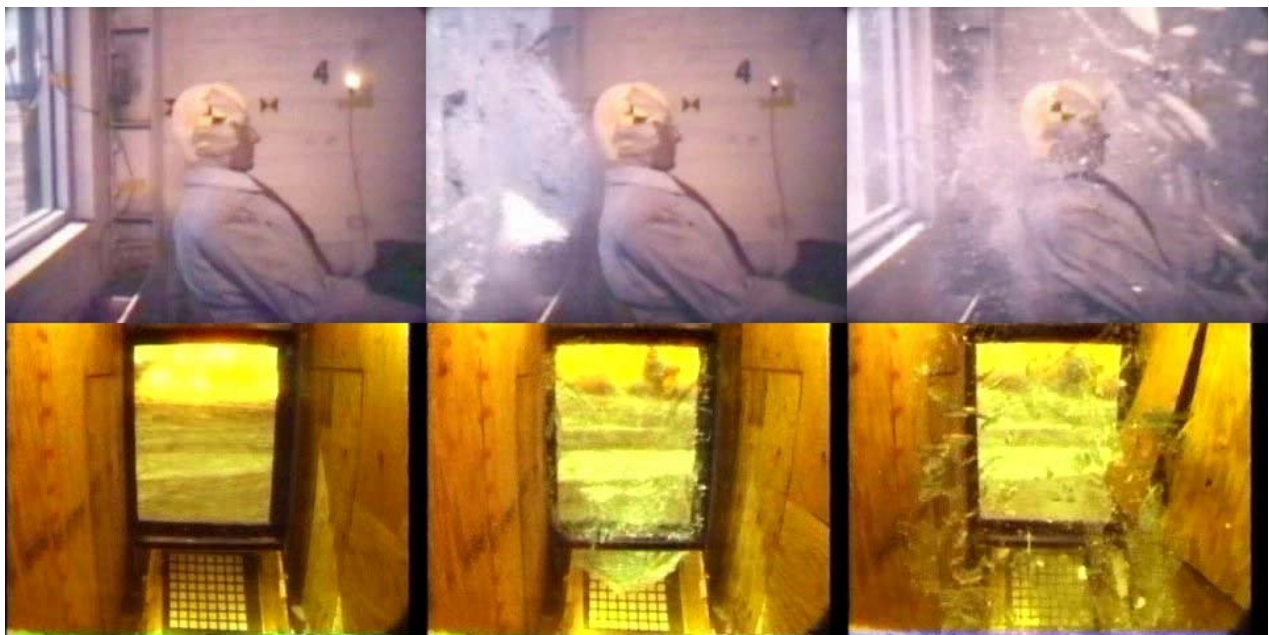
Bild 1 Bersten einfacher Fenster nach einer Explosion (Quelle: US Army Corps of Engineers)
